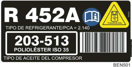
El adhesivo de los gases F indica que este equipo contiene gases fluorados de efecto invernadero.
